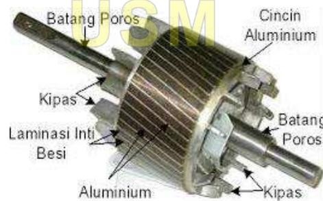
Gambar 2.4. Konstruksi rotor sangkar motor induksi
