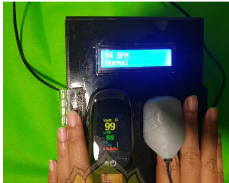
Gambar 4. 9 Perbandingan Alat Rancangan dengan Alat Oxymetri
