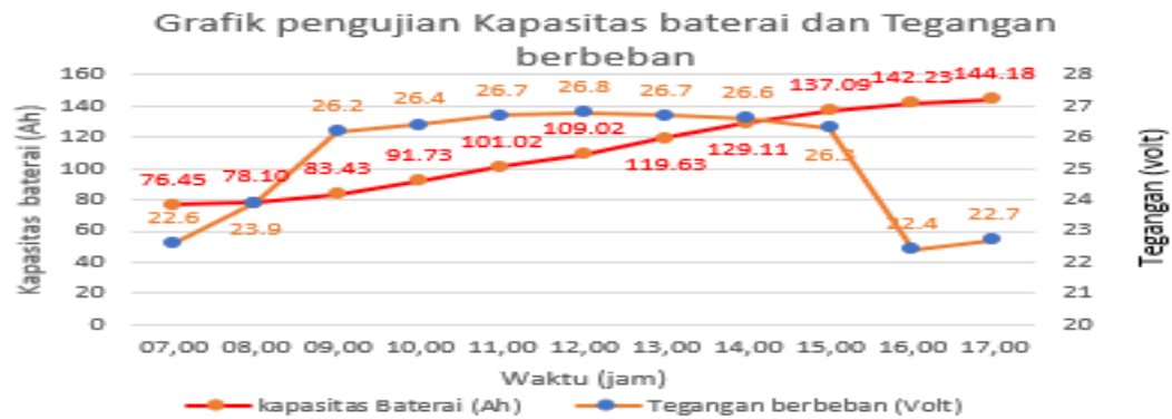
Gambar 4.9 Grafik Pengujian Kapasitas baterai dan Tegangan berbeban.
